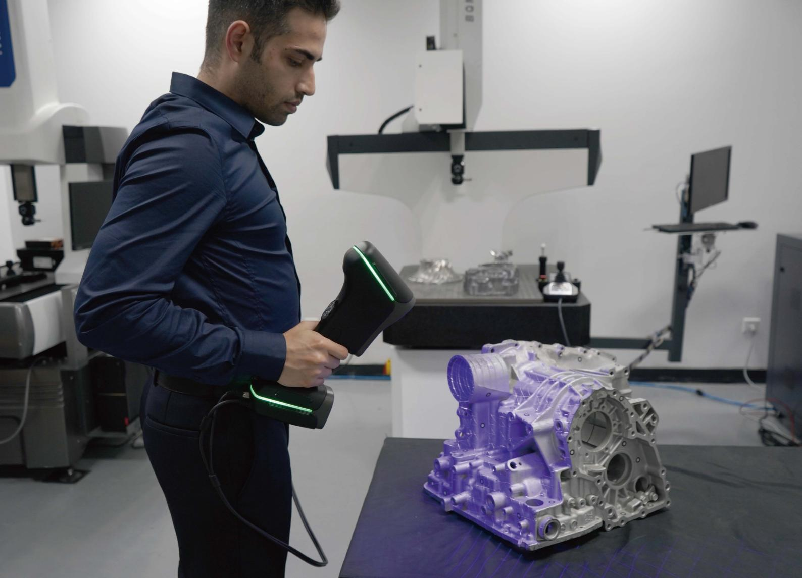
Der 3D-Scanner AXE-B17 verwendet die optische Messtechnik mit einer Scangeschwindigkeit von 2.000.000 Messungen/Sek. Dadurch werden 3D-Daten des Objekts schnell erfasst und präzise Abweichungen auf der geometrischen Oberfläche ermittelt.
